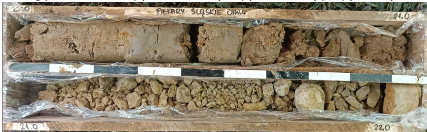
Fot.3. Otwór R4, głębokość 20 – 22 m p.p.t. zwietrzałe i zbrekcjonowane podłoże skalno-zwietrzelinowe
