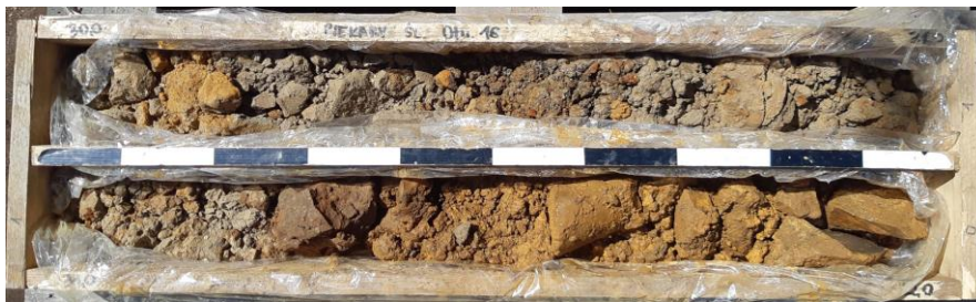
Fot.5. Otwór R16, głębokość 30 – 32 m p.p.t. zwietrzałe i zbrektonowane podłoże skalne, rdzawe naloty, ślady przepływu wody
