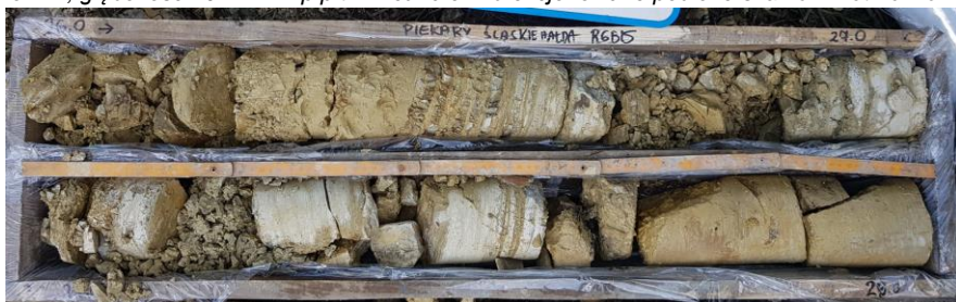
Fot.4. Otwór R6bis, głębokość 20 – 22 m p.p.t. zwietrzałe i zbrekcjonowane podłoże skalne, wtórne wypełnienia
