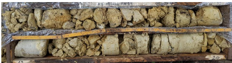
Fot.1. Otwór R3, głębokość 18 – 20 m p.p.t. zwietrzałe i zbrekcjonowane podłoże skalne
